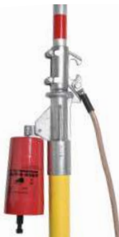
DETALIU CUPLARE PRĂJINĂ ELECTROIZOLANTĂ CU PRĂJINA METALICĂ
