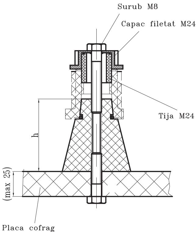
4. După montajul tuturor dispozitivelor poziționate conform figurii, se toarnă beton până se obține grosimea de placă dorită. Pentru uniformizarea betonului se recomandă folosirea unei plăci vibrante pe care se așează cofragul pentru placă.
