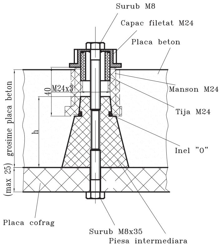
5. După întărirea betonului se deșurubează șurubul M8, capacul filetat M24 și tija M24; se deșurubează șuruburile M8x35 și se scoate placa cofrag. Se reînșurubează șuruburile M8x35 în piesele intermediare pentru a permite scoaterea acestora prin tragere din placa de beton.
