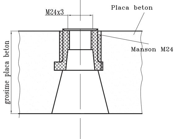
6. Se înfiletează tija asamblată cu elementul filtrant în manșonul M24 înglobat în placa de beton.
