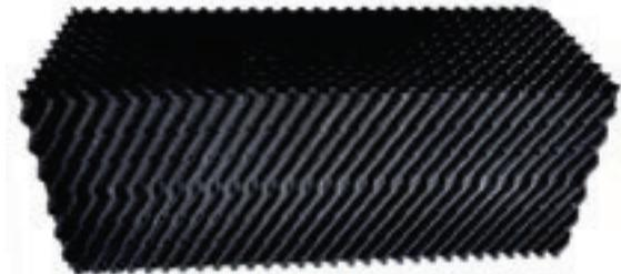
Pentru intensificarea proceselor de schimb de căldură și substanță ce se realizează în volumul umpluturii, plăcile individuale se succedă astfel încât aliniamentele gofrajelor plăcilor adiacente să se încrucișeze între ele.
