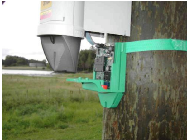
Fig. 10 ComTroll 120 GLM se montează în interiorul suportului LineTroll.
